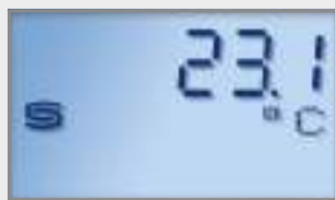
Программируемая индикация на дисплее xx-ECATP Typ 2
